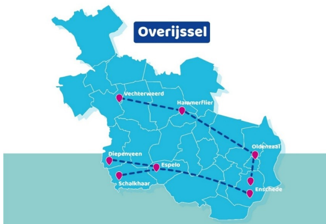
Afbeelding 1: schematische weergave drinkwaterverbinding Overijssel, met een noordelijke en een zuidelijke tak
